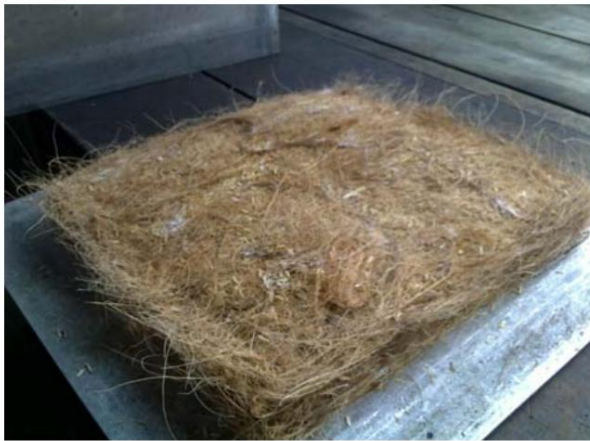
Gambar 21: Hasil pemampatan (cool press) dan Bahan sedia untuk masukkan di dalam 'hot press'
