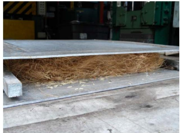
Gambar 21: Hasil pemampatan (cool press) dan Bahan sedia untuk masukkan di dalam 'hot press'
