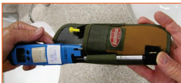
Rajah 2. Probe EC dimasukkan ke dalam perintang pada holster untuk memeriksa kalibrasi (Doran & Kucera, 2012).
