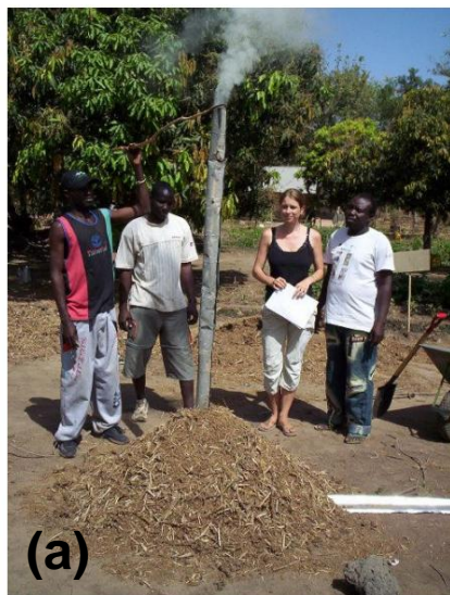
Rajah 3.4: Pengeluaran sekam millet berkarbonisasi di Gambia (a) dan perincian saluran masuk udara yang digunakan untuk memastikan pembakaran yang baik bagi campuran sekam millet (b)
