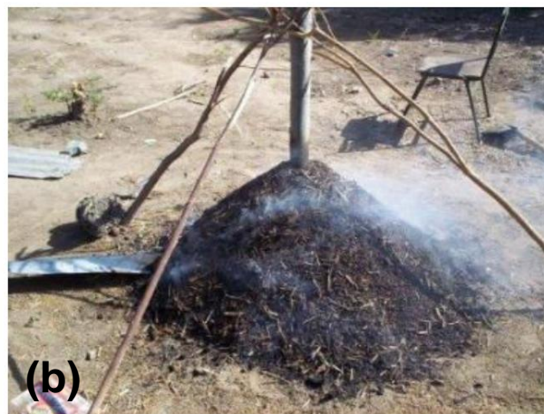
Rajah 3.4: Pengeluaran sekam millet berkarbonisasi di Gambia (a) dan perincian saluran masuk udara yang digunakan untuk memastikan pembakaran yang baik bagi campuran sekam millet (b)
